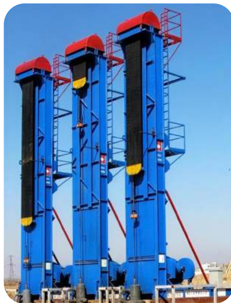
Unidade de bombeamento da torre
